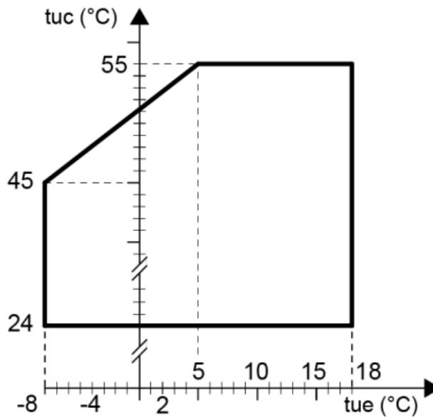
**Tue (°C)** Température de l'eau réfrigérée à la sortie de l'évaporateur
